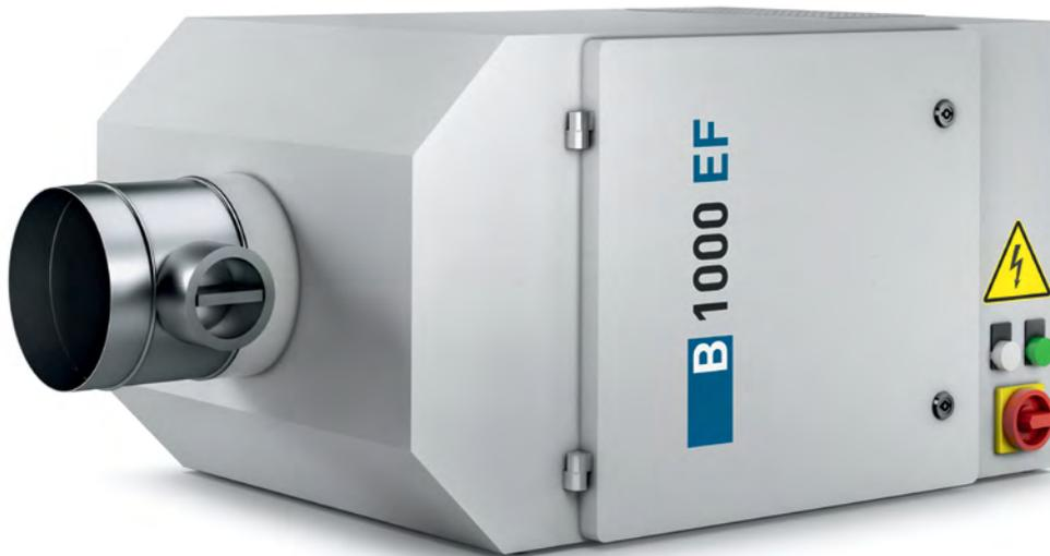
Der Einzelfilter B 1000 ist für kleine und mittlere Werkzeugmaschinen ausgelegt. Kompakt gebaut und mit kleinem Platzbedarf lässt er sich auf oder neben einer Maschine flexibel montieren. Energieeffizient und leistungsstark filtert er Partikel bis  $0,1 \mu\text{m}$  aus Luftvolumen bis  $1000 \text{ m}^3/\text{h}$ . Optimal für die Luftfiltrierung von Öldruck sowie Öl- und Emulsionsnebel.
